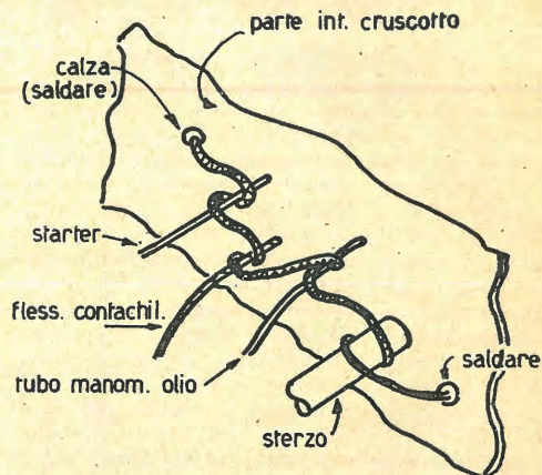
FIG. 2 - Lo sterzo e le diverse condutture metalliche che passano all'interno della carrozzeria dal cofano del motore, devono essere messe a massa successivamente con una grossa calza flessibile.
