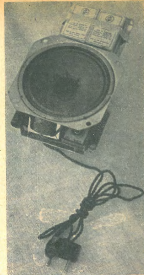
Il complesso alimentatore-altoparlante.
